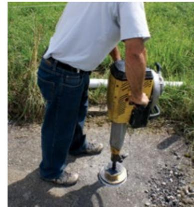
Ramma-System für Asphalt oder gewachsenes Terrain
